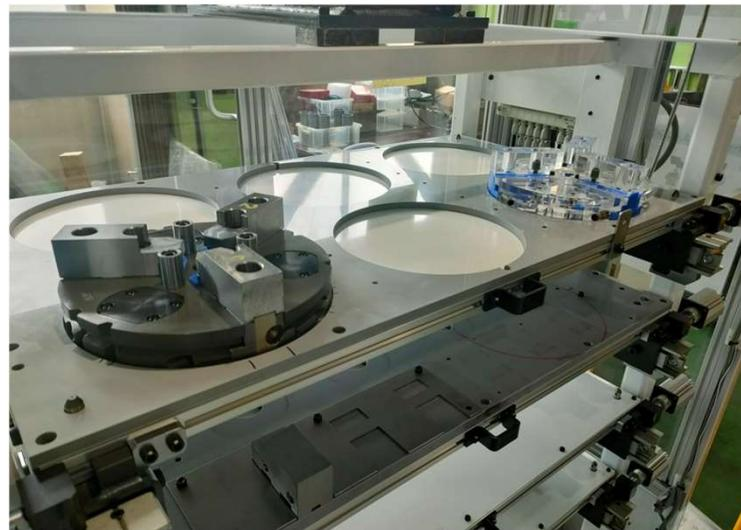
AIO-Mに8inchの交換プレートを載せたモデルです。
