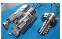
HPC7-01 コンピネーションチャック 加エワーク: 薄物(2mm厚)リング 使用最高回転数2000min-1 チャック中央に3インチェアーチャックを使用し フェイスクランフ。併用したコンピネーションチャック (右: 駆動ロータリージョイント)
