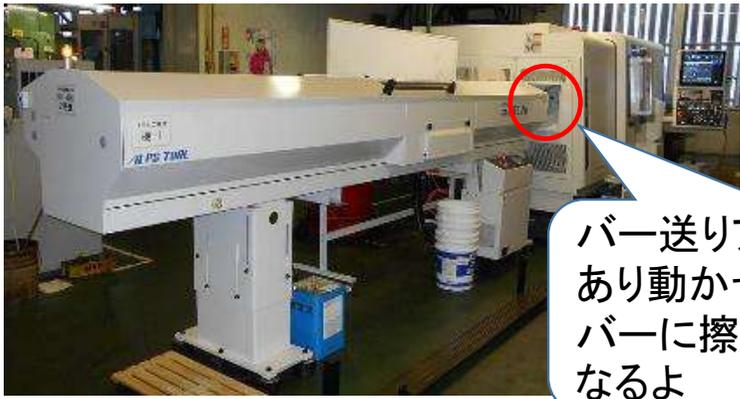
バー送りアンカーが打っており動かさない。手がカバーに擦れて傷だらけになるよ
