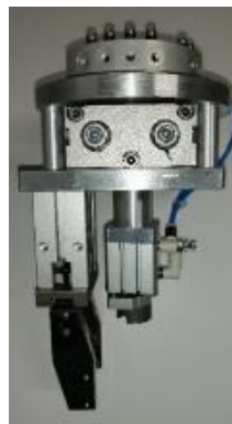
8インチサブ軸爪 交換用ハンド
