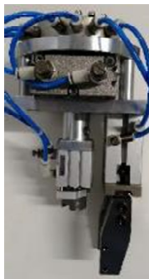
8インチメイン主軸爪 交換用ハンド
