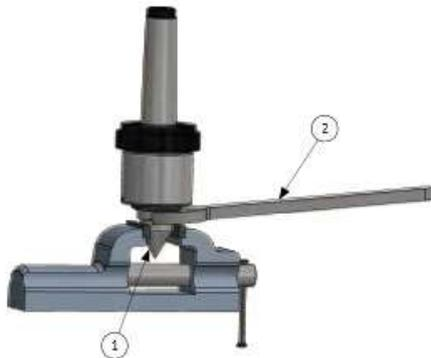
シャフトのベアリングシートへの損傷を避ける為、センタ先端を次のように取外して下さい。
